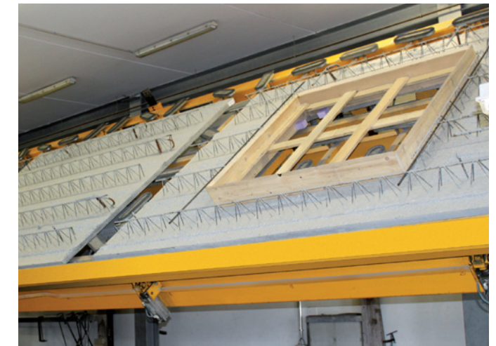
Produktion eines Wandelementes.
